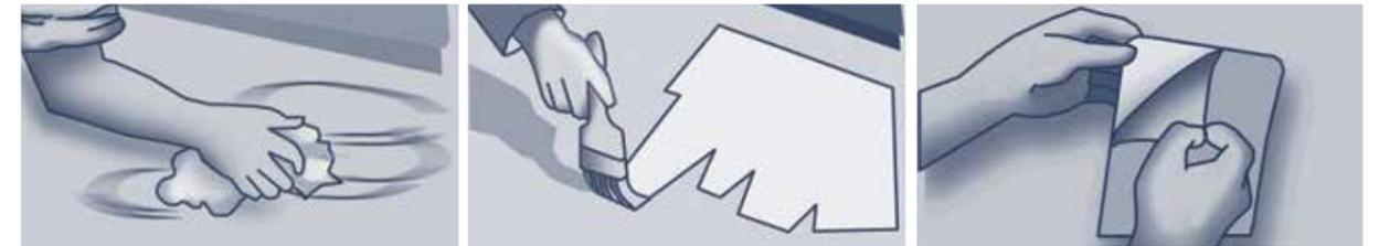
1. Reinigen Sie die Oberfläche mit einem Grundreiniger von Fett- und Schmutzresten. Gründlich mit Wasser nachspülen und vollkommen abtrocknen lassen. Die Minimum-Verlegetemperatur für eine korrekte Verlegung beträgt 4 °C (10 °C für Typ Nasszone, fein).
